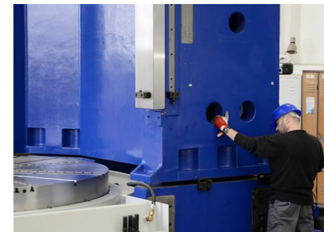
Instalace stojanu na lože
